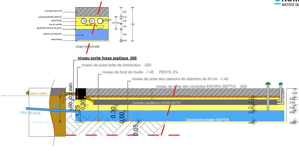
Couverture de 60 cm au dessus des conduites minimum 60 cm dont 40 cm min. de concassé type 0.56 Véhicules légers uniquement Eaux usées et eaux de pluie, séparées
